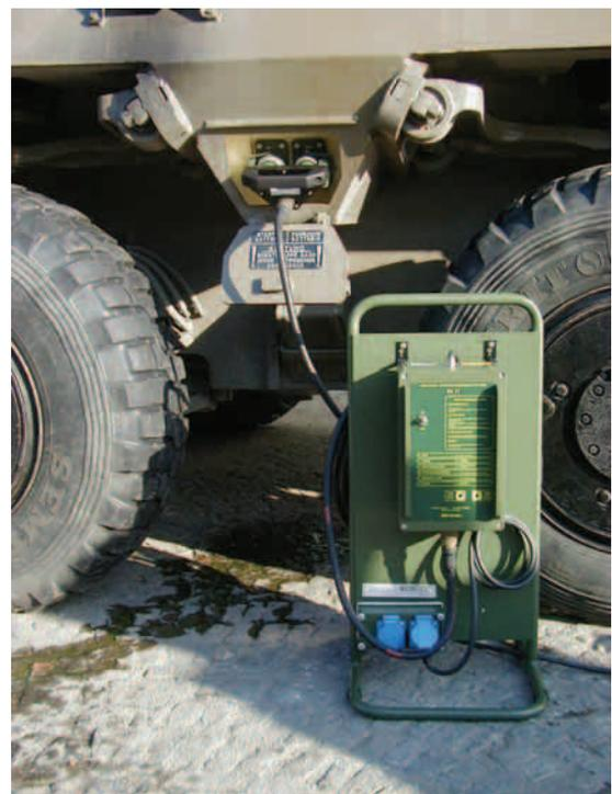
Abb.24: Laden des Fahrzeuges
