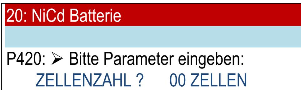
Bei den NiCd-Batterien ist die Anzahl der Zellen einzugeben, die Batteriespannung wird vom Gerät errechnet.
