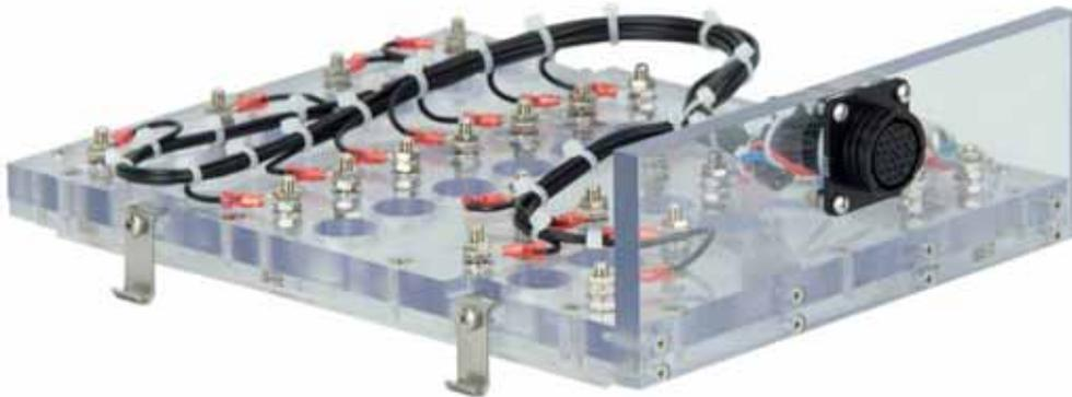
*Abb. Automatischer Zellmessadapter (ohne Temperaturmessung)*
