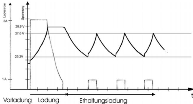
*Typischer Ladespannungsverlauf (teilentladene, geschlossene 24V Bleibatterie)*
