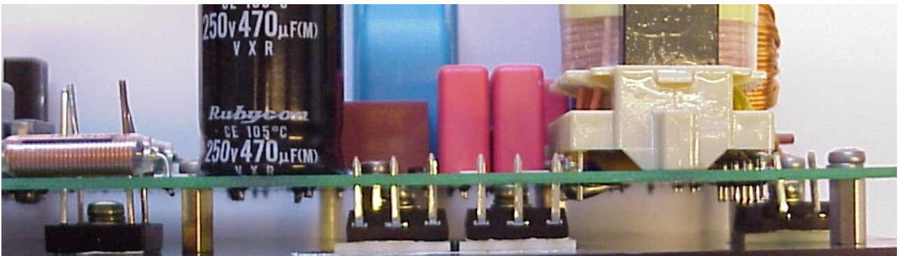
Abb. 26: Leistungsbauteile auf Kühlkörper
