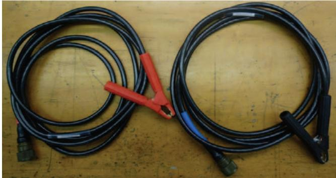
**Abb. 4: BT3001, Zangenkabel 022 A/B, 5m lang**
